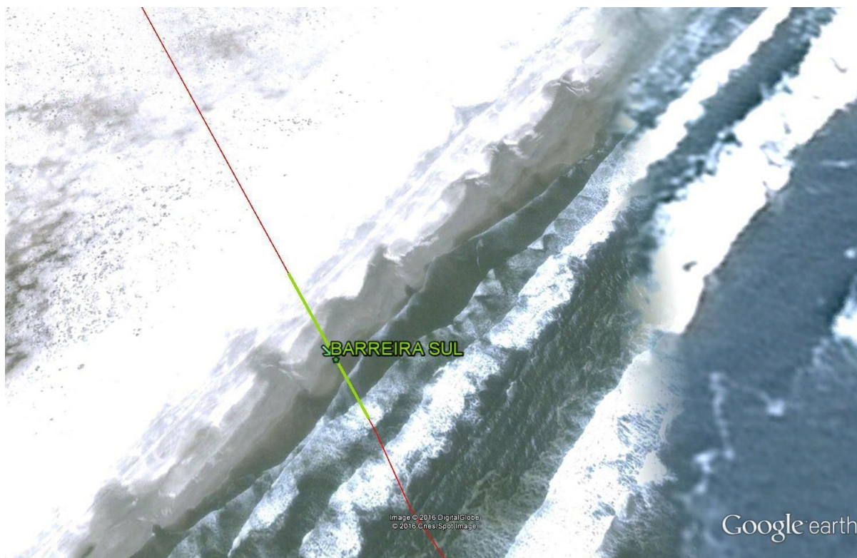
Figura 02. A linha vermelha representa o limite do PNLP. A barreira Sul terá aproximadamente 150 metros de comprimento.
